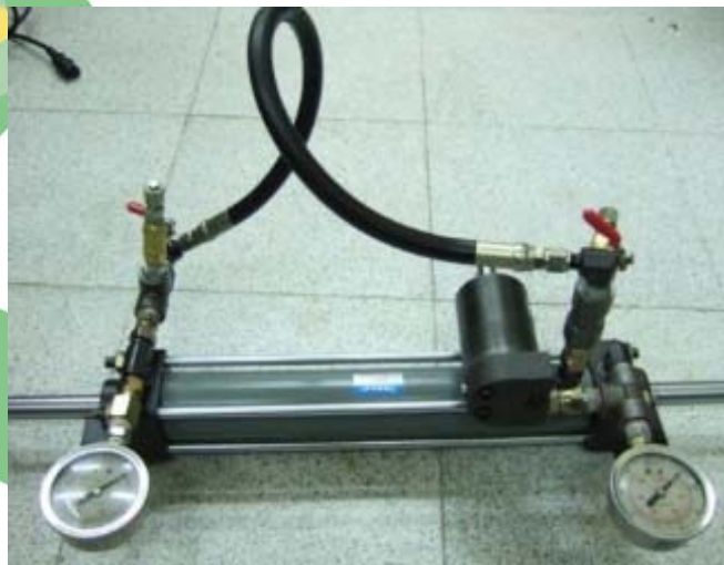
圖1、液壓式慣質機構示意圖及動態模型
