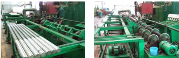
圖 5. 高週波硬化改善後運輸方式(橫式自動化輸送)
