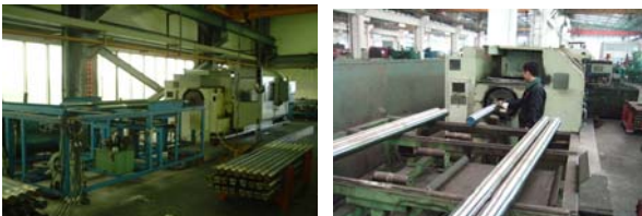
圖 7. 車牙及應力溝改善後運輸方式(後穿輸送式)
