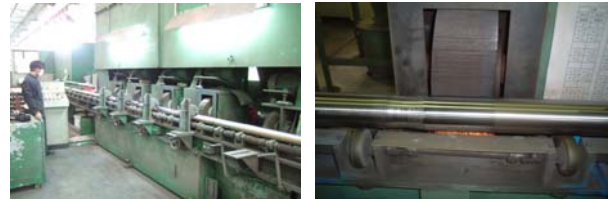
圖 9. 精製外徑改善後運輸方式(橫式自動化輸送、連續拋光)
