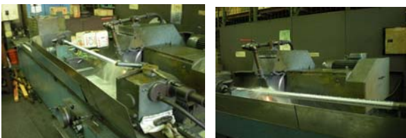
圖 8. 精製外徑改善前運輸方式(天車單支吊掛式、圓筒研磨)
